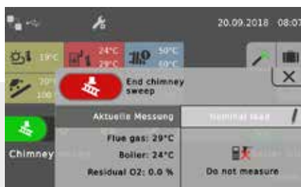
Fig. 2 Overblik over skorstensfejer funktion
