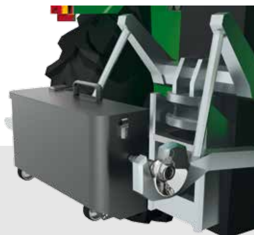
Praktisk hydraulisk enhed til transportning med traktor og let tømning (vippes)
